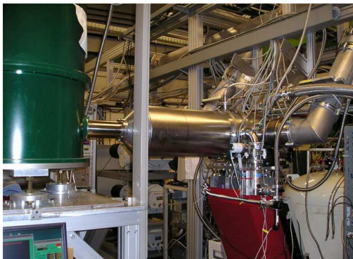
Поляризованная мишень с «замороженным» спином», установленная в 2010 году на пучке меченых фотонов в Майнце.
